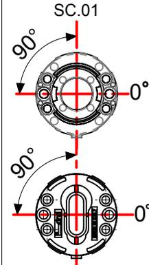
FIG.01: INSERIRE NELLA SERRATURA IL FERRO QUADRO ( 1 ) MANTENENDO LA SCANALATURA VERSO IL BASSO.
