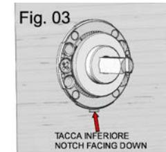
FIG.05: FISSARE LE SOTTO BOCCHETTE CON LE VITI FORNITE RISPETTANDO LO SCHEMA "SC.02" E LA POSIZIONE DELLA TACCA INFERIORE ABBINAMENTO BOCCHETTA .
